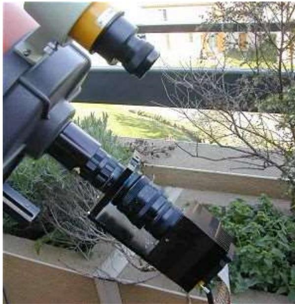
Il peso dello spettro con la fotocamera è di 1,6 kg. Si noti che un drappo nero è un accessorio molto utile per impedire l'ingresso di luce diffusa durante le lunghe esposizioni:
