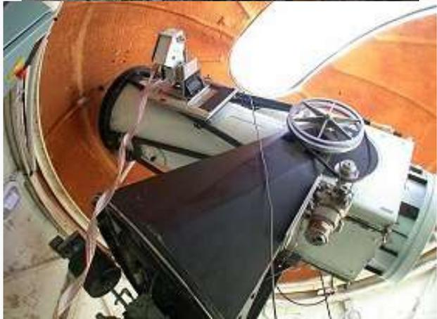
Ci sono tutte le taglie. Va notato che una configurazione con un vecchio Celestron 8 su una montatura GP-DX (in alto) regge perfettamente. In basso, lo spettrografo è montato sul telescopio Pic du Midi da 60 cm, con una combinazione ottica adattata per tenere conto della grande apertura relativa di questo strumento.
