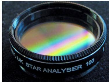
Lo Star Analyser viene semplicemente inserito sul naso di una camera CCD o CMOS (monocromatica) come se fosse un semplice filtro e la camera viene applicata a un telescopio; la luce delle stelle nel campo di vista, tra cui quella di cui si vuole ottenere lo spettro luminoso, viene scomposta e registrata dall'immagine della camera, per poi essere analizzata con software dedicati.
