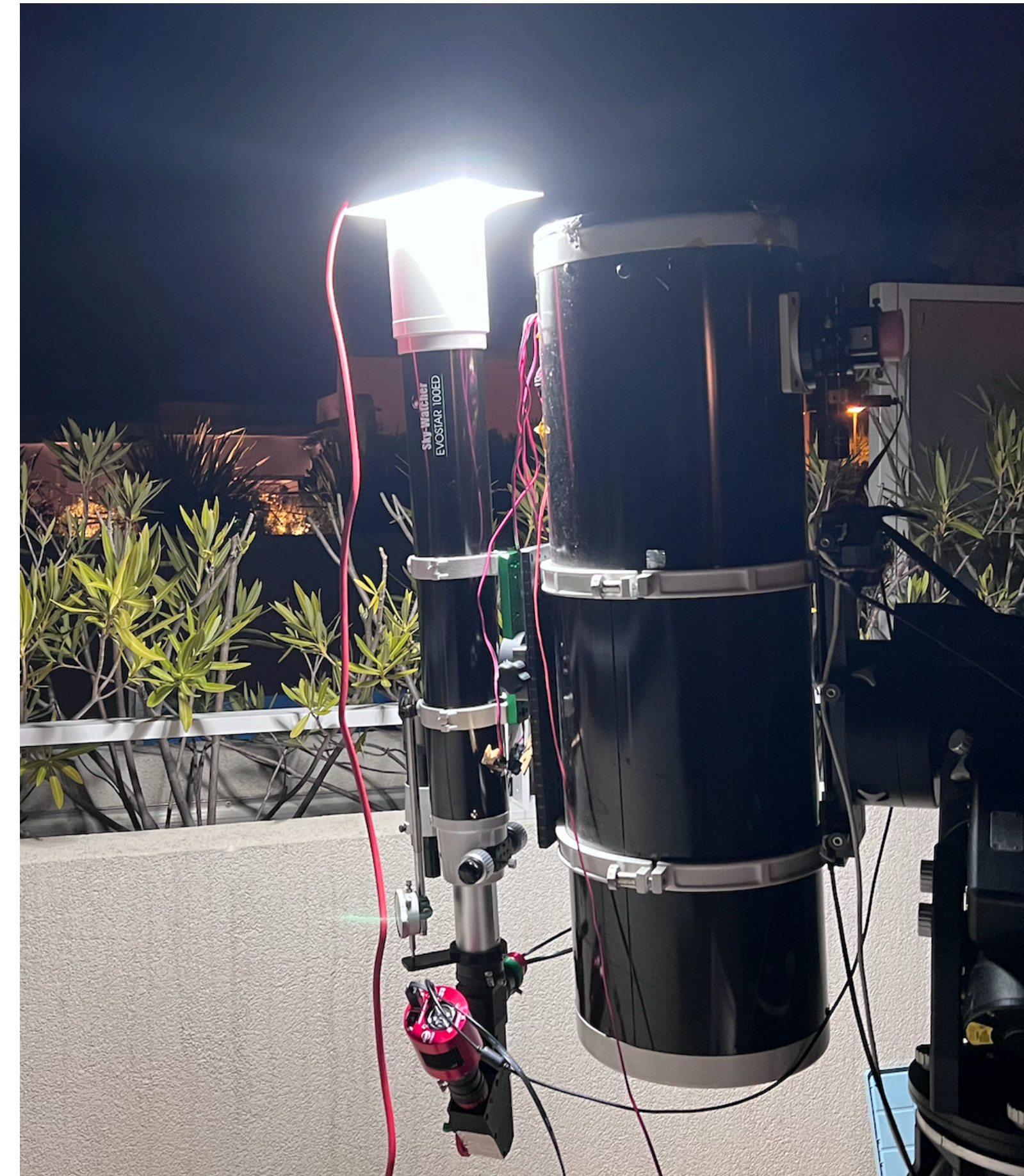
L'étalonnage radiométrique Flat-Field avec panneau LED
